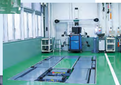
ジオライナーとピットリフト付ワークステージで アライメントサービスに対応
