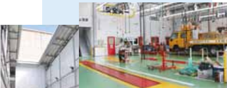
小型工場、一般整備ストールにはフロアリフトを設備
