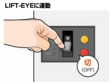
リフトのメイン電源ONでリールボックスが点灯、通電状態をお知らせ。
