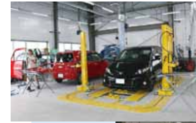
ベンチ式車体修正機で 大ダメージ車両も正確に復元
