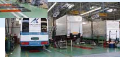
車検整備ストール。キャタピラツインIIは能力16t+16t、フラットキット付
