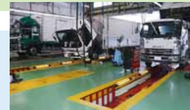
一般整備2ストールにフロアリフトを設備。オイル交換から重整備まで対応
