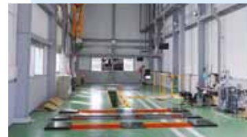
検査ラインにはネットワークProを導入。荷重試験装置も設備
