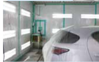
ブース内には水性塗料乾燥装置を内蔵、 部品吊下げ架台はオリジナル装備
