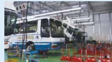
車検整備ストールにはレール式ホイールドローを設備
