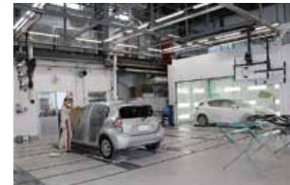
横移動スライドパレットで 下地工程からブースまで スムーズに連携
