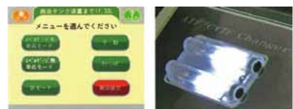
タッチパネル&音声ガイダンスを搭載 LEDバックライトでオイルの色も見やすく
