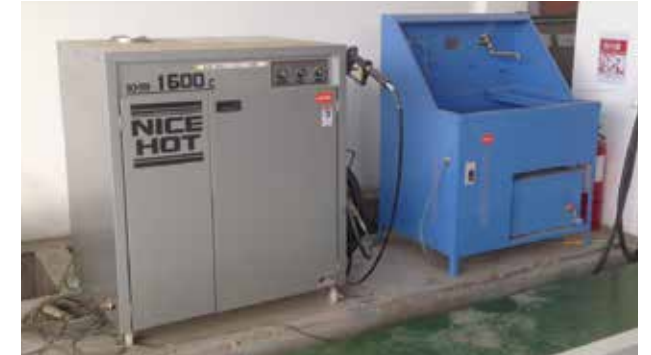
温水洗車機、部品洗浄台などサービス工場同様の周辺設備
