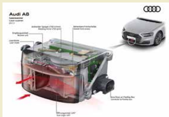
新型アウディA8に搭載されるADAS用センサー。左は世界初採用のレーザーセンサー
