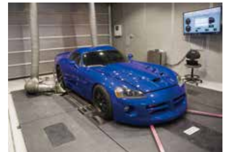
高速走行もシミュレーションできる防音完備のシャシーダイナモーター室も併設
