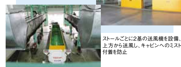
3方向のロールカーテンを下すと換気装置に早変わり、同時に2ストールで塗装作業が可能
