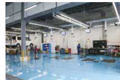
一般整備ストール、タンデムリフト、ビッグワークステージリフトを導入。エアロパーツ装着車の作業も容易に行える。
