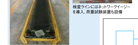
フロアリフト、ピットジャッキを備えたピット、安全のためスライド式のネットを装備
