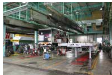
右側3ストールは車検整備としてキャタピラツインIIを3基導入
