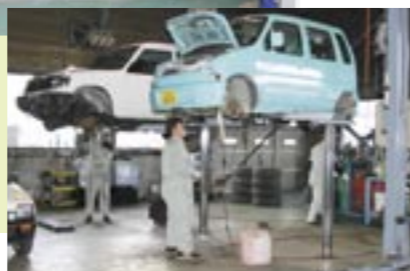
車検整備は6ストール、全ストールにZパスカル等のリフトを導入
