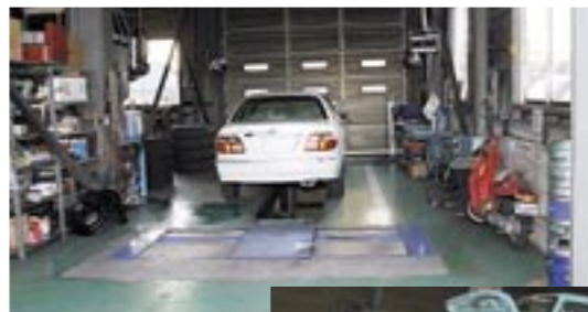
検査ラインにはコンパクト・低騒音タイプのトリプルテスターを新設
