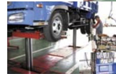
一般整備に作業性抜群のフロアリフトを2レーンに導入。
