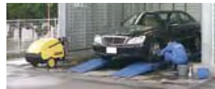
ドライブオンパスカルを設備した洗車場
