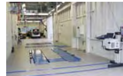
トリプルテスター、ネットワークシステムを導入した通り抜け式の検査ライン
