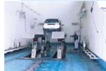
垂直上昇仕様のベガリフトは日本初の導入、左右の照明、サーキュレーターを装備
