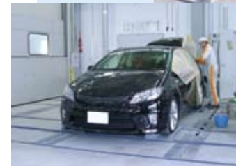
スライドレールとスライドパレットで ブースへの移動も容易
