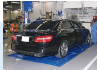
アライメントストールにはワークステージXとマイクロラインを設備
