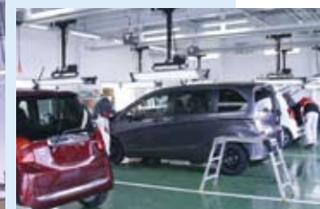
LEDライトで磨きムラや微細な傷も発見が容易
