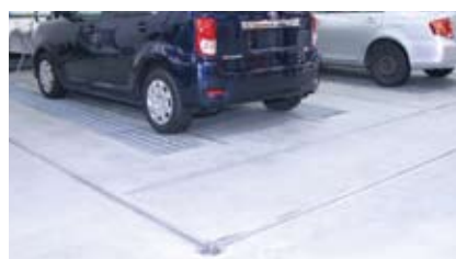
4ストールに床式修正装置を導入、グレーチングは床下吸塵装置
