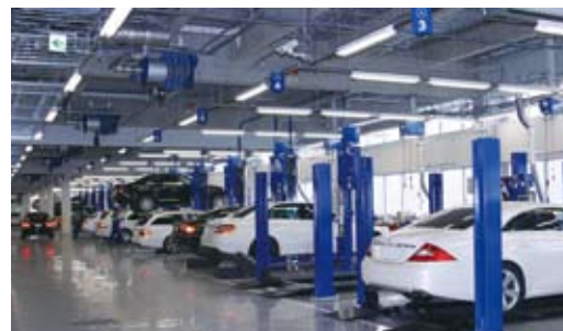
ずらりと並んだ4柱、2柱リフト。天井も高くリフトアップ時も余裕
