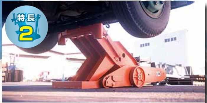
車輪は4輪式で移動が大変容易です。荷重がかかると前2輪が、沈み込むためリフトアップ時に安定しています。
