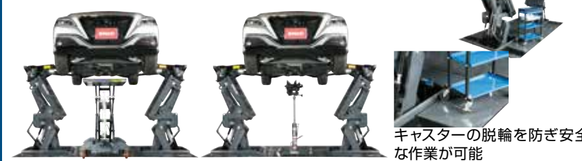
リンク機構の工夫によりリフトは垂直に昇降します。
