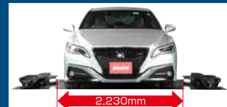
アームキャリッジ間は2,230mm。アームを最下限まで下げなくてもクイックに車両の退出が可能です。(アーム上面がFL110mm 以上の場合) ※LED照明部へ接触しないようご注意ください
