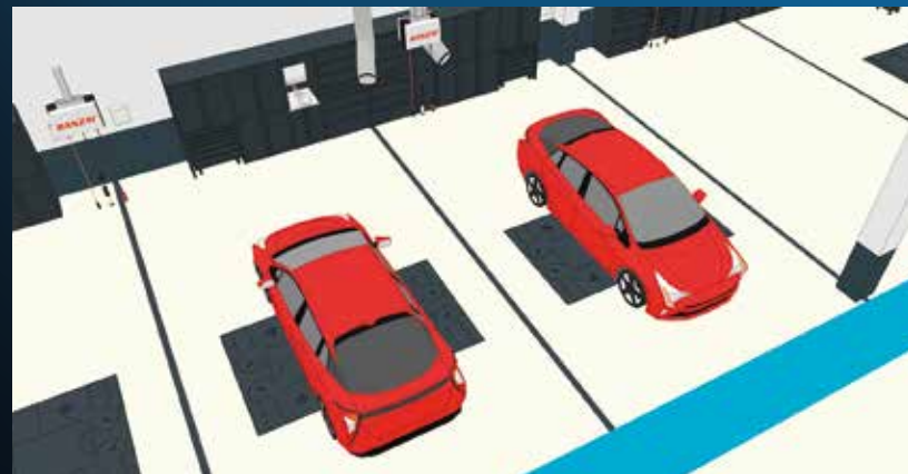
EVバッテリー着脱など作業しやすい車両方向でリフトアップ可能
