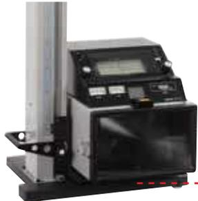
ランプの位置が低い車両への対応、また、前部霧灯(フォグランプ)の測定もできるようにランプの取付高さの移動範囲を25~120cmに拡大。
