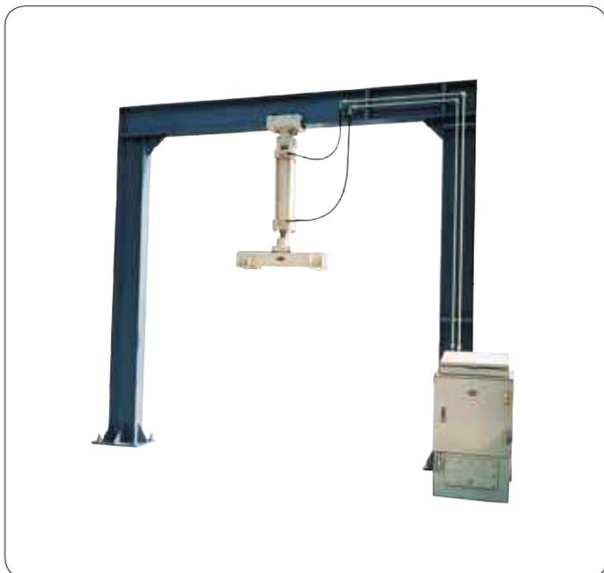
土砂等を運搬する大型車(ダンプ、トラック等)に取付けられた自重計に、積載重量と同等の荷重をかけることにより、そのメーターの性能検査並びに調整が行える装置です。
