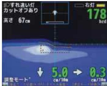
CPUによる細かい画像解析により、画面上に、Z型マークを表示します。(HT-517は除く)
