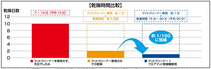
比較した場合。(群馬県内某所での実測値を参考) ※2:フロアマットの種類により、乾燥時間、枚数が異なります。
