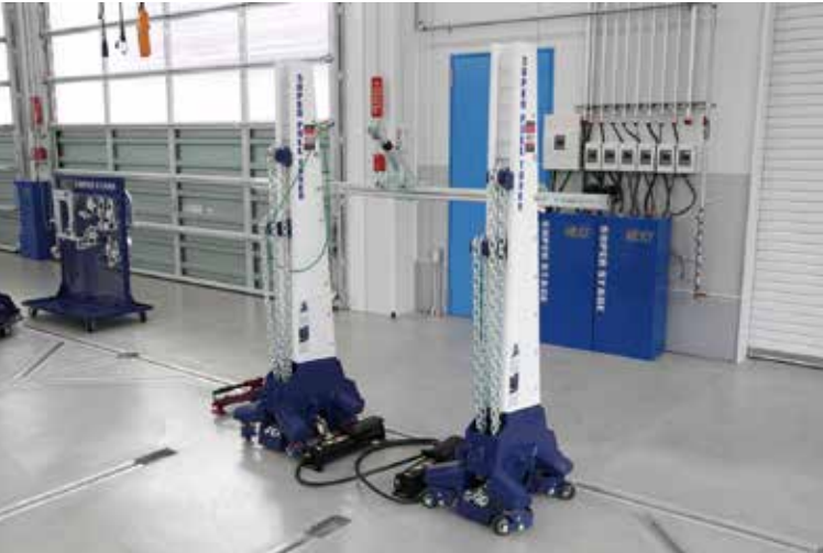
スーパーブルタワー SP-2700 (大型車キャビン修正に最適) 10トンタワーポスト NR-1600 (10tコストパフォーマンスタワー) スーパーサブタワー NR-1590-4TS (軽損傷・補助に最適)
