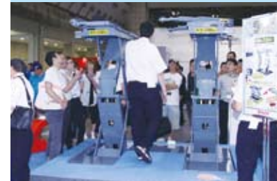
「イーグルNXリフト」は能力3.2トンのパンタグラフ式、プレート式は 既存のイーグルリフトのピットにもそのまま設置可能
