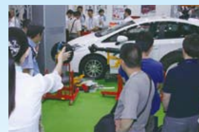
省力化に貢献する各種リフター、クラッチ、プロペラシャフトなど重量部品の脱着も安全に行える
