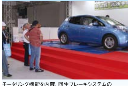
モータリング機能を内蔵、回生ブレーキシステムの 診断にも活用が可能なMAHAのシングルローラー式 四輪同時シャシーダイナモメーター「MSR500-3」
