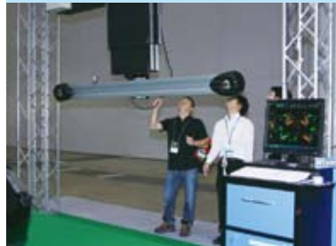
新型クランプを採用した 光学式アライメントテスター「ジオライナー GL-680-2」
