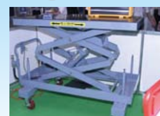
バッテリーの取り外し、取り付けが安全に行えるEVバッテリー用リフター
