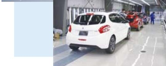
コンベアラインで流れる標準検査のエリア
