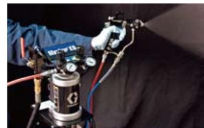
下回り塗装では、エースプレーによる塗料の噴霧が一般的ですが、「マーキュリーES」は塗料自体を高圧に加圧し、塗料を微粒化させることで効率的な塗着を実現します。塗料のコストダウンが図れるエアアシスト塗装システムです。
