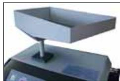
エレメント交換時に出る廃油は上部オイルドレンで回収・計量します。
