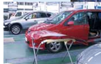
作業場所に応じて開閉できる集塵ビットを設備。
