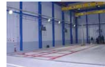
ヨサム大型車修正用レールとキャブ修正タワーを導入。
