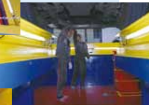
フロアリフトにはピットリフトを装備、重整備にも対応。
