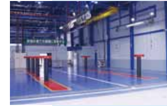
車検整備ストールには4柱、2柱のキャタピラツインエースを設備。
