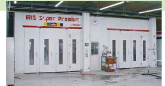
(左)塗装乾燥ブース、(右)サンディングブース、各1基を導入
