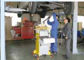
3次元計測器で高精度修復を実現
