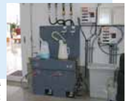
給油・廃油キャビネットでおイルサービスを集中化
