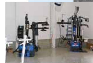
タイヤチェンジャーは2台、高扁平タイヤ、ワイドタイヤにも対応
