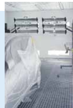
床面を広く集塵ピットとした「プレパレーションシステム」で集塵能力を大幅にアップ
