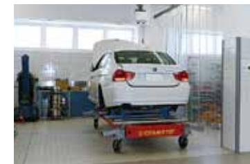
セレット「セベン」など2基のベンチ式 修正機で精密な車体修正を実施
