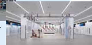
簡易塗装ブース「アイリスオープン」が5基(左)、 塗装・乾燥ブース「アイリスクリーンパフォーマンス (BMW仕様)」が3基(右)。 BMW純正水性塗装「カラーシステム」に対応
