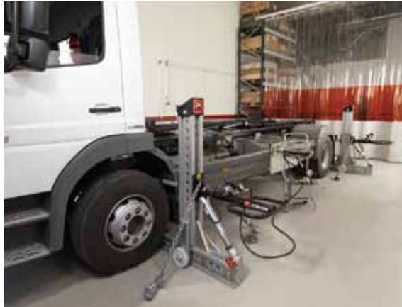
既存ストールで大型車のフレーム修正に対応
