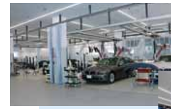
中央の4ストールには吊下げ式乾燥装置、 カーテンを設備
