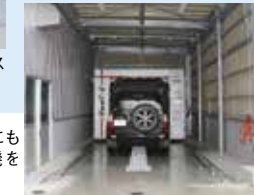
下地工程には横移動レールと開閉式吸塵ダンパーを設備
