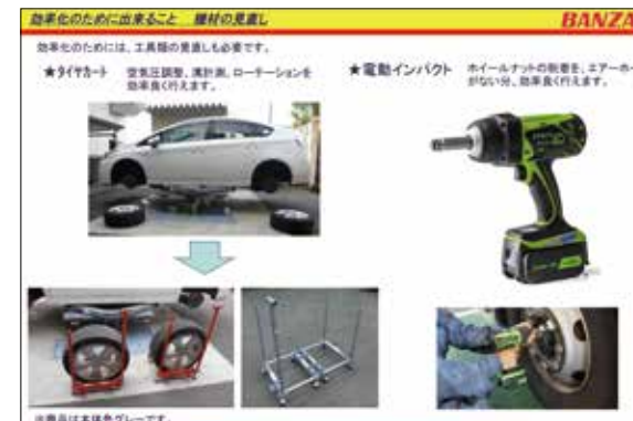
タイヤ&ホイールの脱着・交換を容易にする「タイヤカート」(左)、エアホースの脱着がなく効率的な「電動インパクト」(右)
