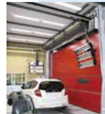
天吊り式乾燥装置、ブース横面からレールで移動
