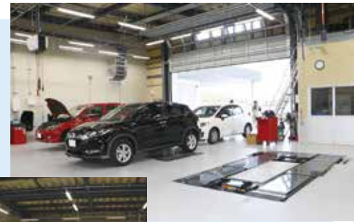
点検整備ストール。タンデムリフト2基、ワークステージXリフト1基を導入
