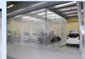
下地工程には横移動レールと開閉式吸塵ダンパーを設備
