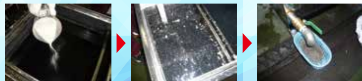
①凝集剤を投入
