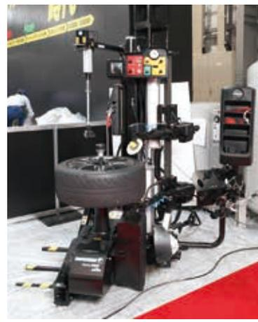
下ビード作業用モニターを搭載、新型レバーレスタイヤチェンジャー
