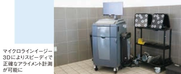
マイクロラインイージー3Dによりスピーディで正確なアライメント計測が可能に
