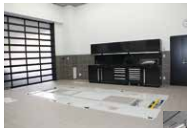
センター正面側の準備室。ドライブオン&フリーホイール対応のダブルバスカル、前後にビットジャッキを装備
