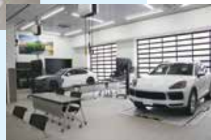
1つのトレーニングルームに3ベイをあて、特注ダブルバスカルとフラットアームタイプの特注ネオバスカルを各1基設備
