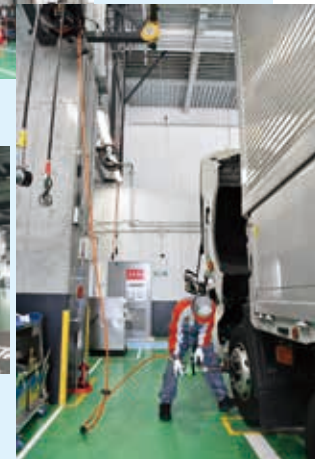
大型インパクトレンチも楽々、インパクトバ ランサーをストールの4隅に配置。 前後方向への移動もスムーズ
