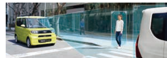
衝突被害軽減ブレーキの作動イメージ
