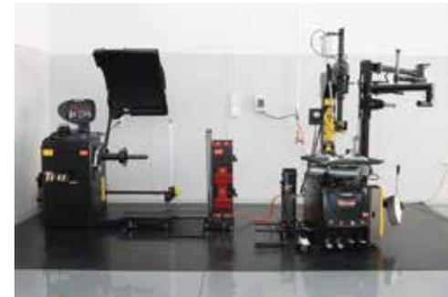
超低床型タイヤリフトを備えるホイールバランサー「トリムBP-68」(左)、レバーレスユニット搭載タイヤチェンジャー「アスリート2LL」(右)
