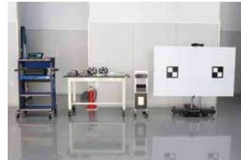
「OBD検査」の核となる検査用・整備用スキャンツール「MST-nano」(左)のほか、エイミング作業時の位置決め、ターゲット設置などを効率化する各種補助ツールも常設
