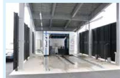
門型洗車機、下部洗浄機を設備。洗車作業の負担を大幅に軽減。
