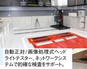
自動正対/画像処理式ヘッドライトテスター、ネットワークシステムで的確な検査をサポート。
