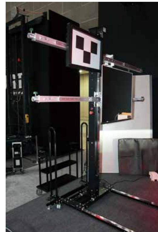
ターゲットなどの設置位置情報を収録した専用ソフト「Q.mApp」(キューマップ)と、システムごとに異なるターゲットの図柄を切り替えてディスプレイ上にデジタル表示可能な「eターゲット」を組み合わせたエイミングシステム「Q-DAS」
