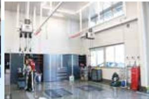
エアの架台を設置した車検ストール。
