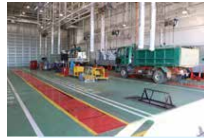
4柱キャタピラツインIIを2基。4台まで同時整備が可能な「タンデムレーン」。
