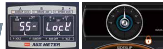
「トリプルテスター」(左)とオプション「サイドスリップセーフティロック」による踏板ロック時のデジタルメーター(中央)／グラフィックメーター(右)画面イメージ
