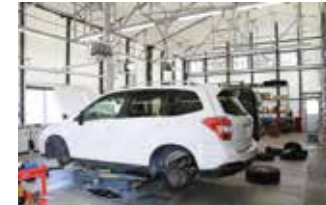
照明とテント素材の透過光も寄与して明るい作業環境に。
