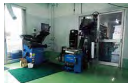
タイヤサポートアーム標準装備のタイヤチェンジャー、「モンティ3300 SRAC」（右）とホイール balancer「ゲオダイナ7800」を設備。
