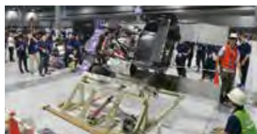
車検ではブレーキ、騒音、チルト試験（写真）などを実施。今回通過し動的審査に進めたのは48チーム、全体の約2/3だった
