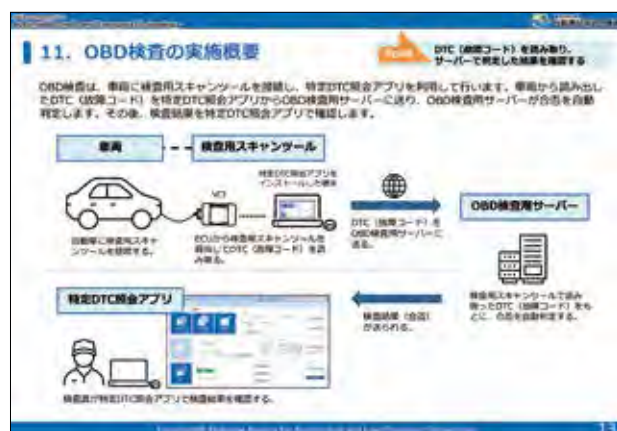
OBD検査実務とDTCデータの流れ (出典：自動車技術総合機構)
