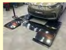
スナップオンエクイップメント社のタイヤ溝測定器
