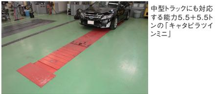
中型トラックにも対応する能力5.5+5.5トンの「キャタピラツインミニ」
