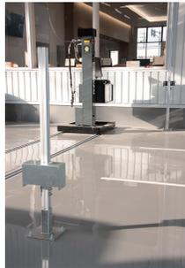
車検ストールには「トリプルテスター」と「固定式フリーローラー」を設置。「HT-538」にはヘッドライト中心から受光部までの間隔を約1mとしやすい「車両誘導装置」を追加。
