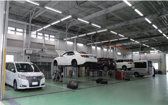
B街区工場内観。写真手前側に、「タンデムリフト」フラットプレート・アーム式2基の間を挟むようにして「タンデムリフト」フラットアーム式を1基ずつ配備している
