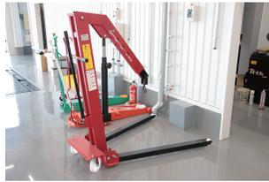
小型トラックのエンジン・トランスミッション交換など重整備対応を見据え、能力11tの低床型エンジンリフターを先行投入。
