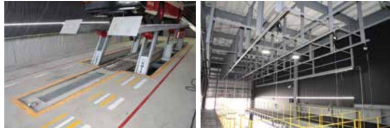
雪が付着した車両も「ベガリフト」(左上)でそのままリフトアップし、「エスコートレール」を完備したキャットウォーク(右下)からルーフを、移動式「ポートウォッシャー」(左下)で下回りを洗浄できる「洗車場」。キャットウォークから見た車両のルーフ(右上)
