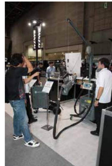
溶接条件を自動設定でき超高張力鋼板にも対応する「インバータスポットNex Gen」。
