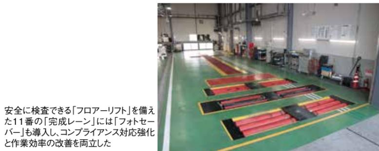
安全に検査できる「フロアーリフト」を備えた11番の「完成レーン」には「フォトサーバー」も導入し、コンプライアンス対応強化と作業効率の改善を両立した
