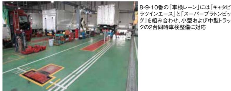
8・9・10番の「車検レーン」には「キャタピラツインエース」と「スーパープラトンビッグ」を組み合わせ、小型および中型トラックの2台同時車検整備に対応
