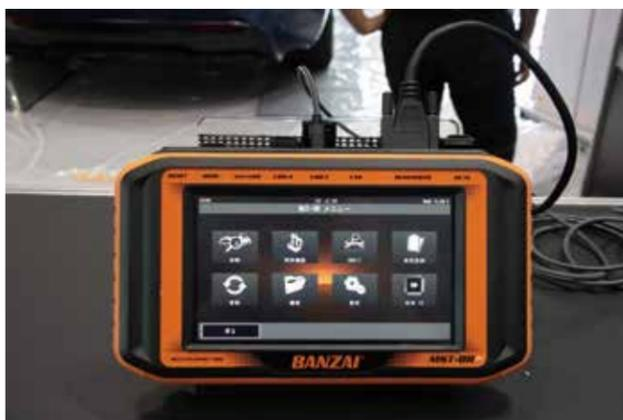
「検査用スキャンツール」と「整備用スキャンツール」双方の要件に適合する一体型スキャンツール「MST-8R」
