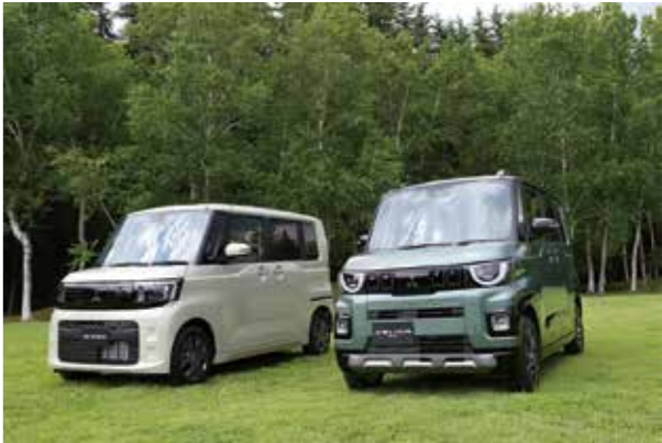
2025年10月に発売された新型日産ルークス(左)と三菱eKスペース／デリカミニ(右)。先代はマイルドハイブリッドを全車に搭載していたが、新型ではICVのみとなっている
