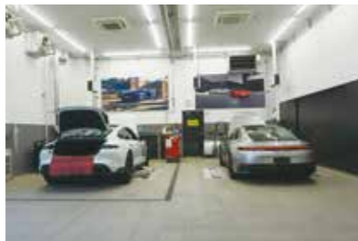
EV の専用ストール。電動カーテンを設備し、高電圧作業の整備に対応
