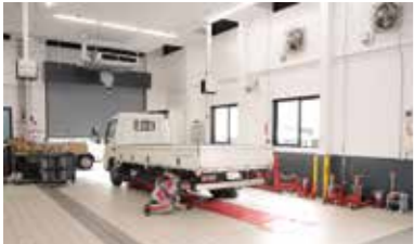
能力 5.5t + 5.5t の「キャタピラツインⅡ・ミニ」はトラック・バスの整備効率向上に大きく貢献している。
