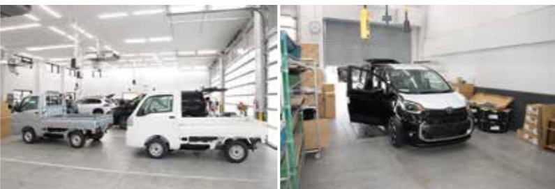
新車整備を担う本社新車棟は大半が平場だが、エアロパーツやホイールなどを装着するため「タンデムリフト」を1基導入している。
