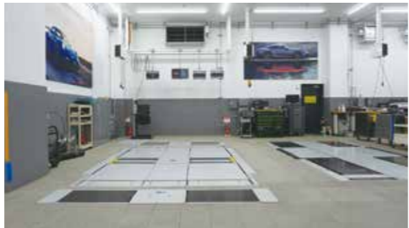
4WD やホイールベースが長いポルシェに最適なスーパーマルチテスターを採用した検査ライン
