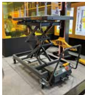
能力1.5tの電動油圧のバッテリーリフター。
