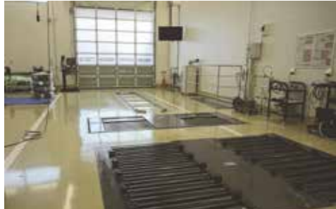
トリプルテスターを採用した検査ライン。4WD車の多い北海道ではフリーローラーは必須。
