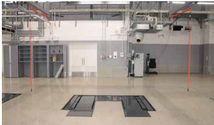
長崎トヨベット佐世保店では唯一、天井吊り下げ式ホースが設置されたSQ車検ストール。
