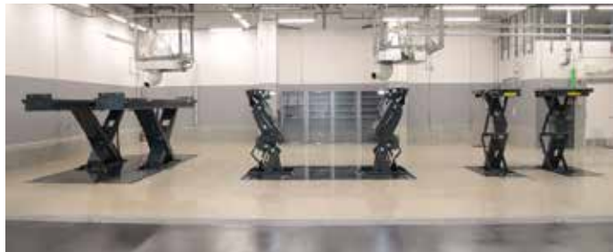
(上) 写真左より能力5tの「フラットワークステージX」、同4tの「イーグルアドバンスリフト」、同3.2tの「イーグルNXリフト」。(下)ホースはキャビネットに収納される。
