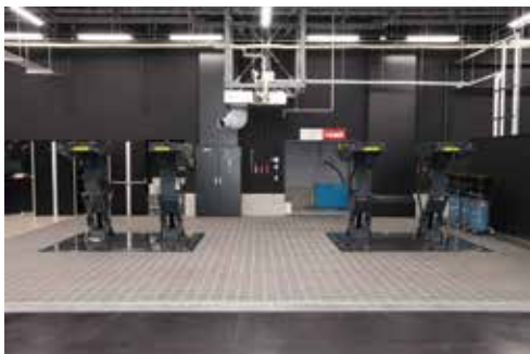
特別な仕立てのレクサス車専用ストールには上昇・下降時とも床面がフラットになる能力3.2tの「イーグルFXリフト」を2基導入。
