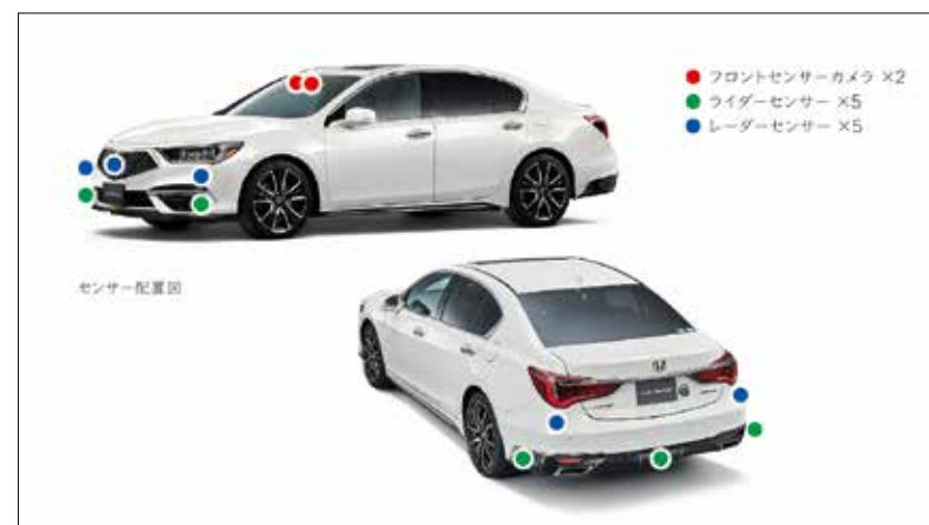
自動運転レベル3型式指定を初めて取得したホンダ・レジェンドホンダセンシングエリートとそのセンサー構成
