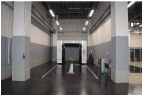
特別な仕立てのレクサス車専用ストールには上昇・下降時とも床面がフラットになる能力3.2tの「イーグルFXリフト」を2基導入。
