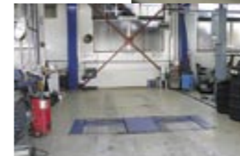
トリプルテスターを設置した検査ライン
