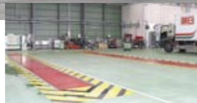
大型フロアリフトを2ストールに導入
