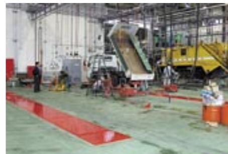
フロア全面をフラットに、とニューキャタピラツインを4ストールに導入
