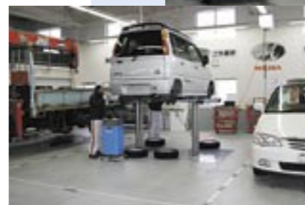
タンデムリフトは2系統の油圧システムで安定性抜群
