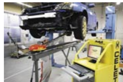
「高精度な車体計測に不可欠」として導入されたセレット「ナジャ」
