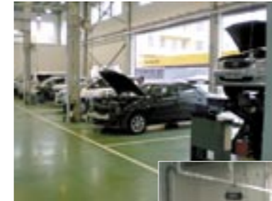
1Fのリフトは床面フラットのパンタグラフリフトを導入
