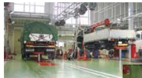
左、4柱式ツインエースで大型低床4軸車に対応、通り抜けのストールとして前後2台入庫も容易。右は3柱ツインエース
