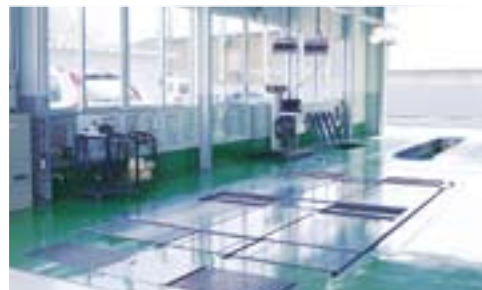
検査ラインには4WD対応のスーパーマルチテスター、ネットワークシステムを導入
