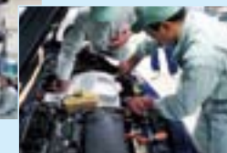
コンバーターの脱着作業
