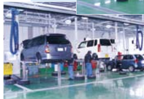
床面がフラットになるタンデムリフトで作業性向上
