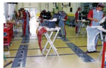
下地工程には床面吸塵装置、ブースへの移動レールを設備
