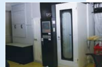
粉塵の除去、静電気を防止するエアシャワールーム
