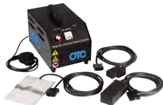
IHクッキングヒーターなどと同じ原理の電磁誘導加熱を利用し、プラスチックやガラスを加熱せずに、金属だけを加熱する事が可能な機器で钣金作業をはじめ、いろいろな整備作業に応用できます。(当機器はご使用にあたり、総務省通信局への設備登録が必要になります。)
