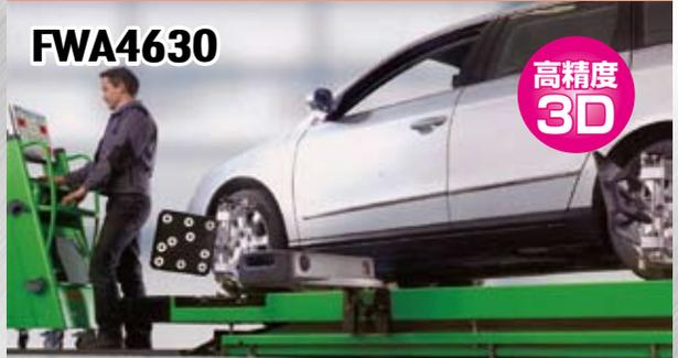
**カメラ用ポストの設置が不要** センサーヘッドはリフトに設置。
