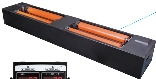
静音型エンボスローラー スピード測定時の騒音を大幅に減少 ハイブリッドエンボスローラー エンボスローラーと溝型ローラーの特長を融合させたローラー 溝型ローラー 耐久性に富んでおり、特に降雪地域に有効
