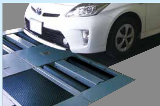
サイドスリップテスターとコンビネーションテスターをお好みのレイアウトに設置可能
