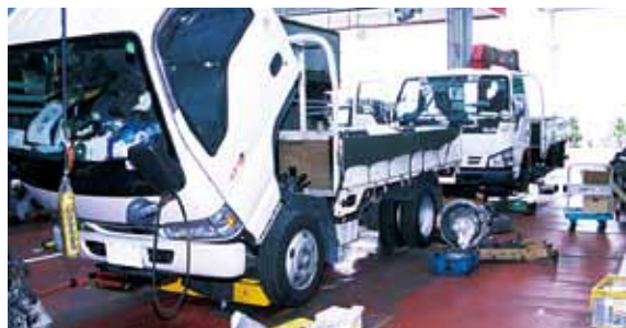
前後2台同時に使用して整備している例
