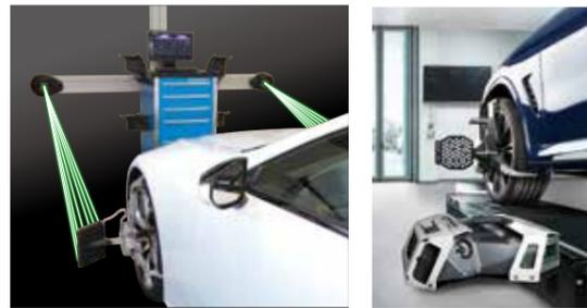
※左右1mm以内、前後対角2mm以内の高精度なランウェイレベルを確保することで、信頼性が高いアライメント測定・調整が可能。
