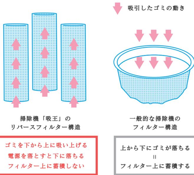
フィルターを逆向きに設置した独自の「リバースフィルター構造」フィルター上にゴミがない状態をつくるのでフィルターの目詰まりを防止できます。
