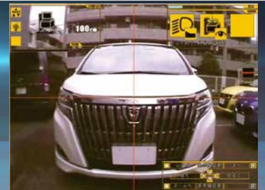
テスターの後ろからスコープを覗き込む必要が無く、モニター画面を見ながら車両正対ができます。車両正対時間を大幅に削減します。
