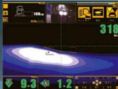
CPUによる細かい画像解析により、画面上に、Z型マークを表示します。(HT-519は除く)
