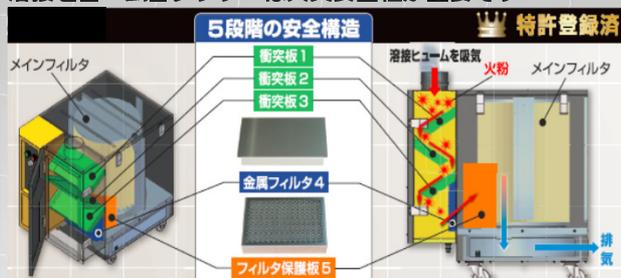
溶接作業では、ヒュームだけでなくスパッタ（火花）が発生します。そのため、溶接作業で使用するヒュームコレクターには、吸引したスパッタが直ちにフィルタに触れないなどの火災対策が必要です。コトヒラ工業の溶接ヒュームコレクターは、3層の衝突板+金属フィルタ+フィルタ保護板による5段階の消火機構を備えており、火災安全性にも配慮した構造となっています。さらにご心配な場合、オプションで消炎ボックスのご用意もあります
