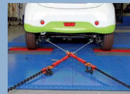
車両固定装置 前側用ベルト、後側用チェーン(写真)、 ワイヤーが付属
