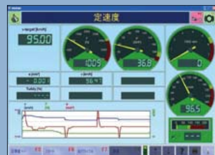
負荷シミュレーション画面 アナログメーター、デジタルメーター、 グラフにどのデータを表示するかを指定可能
