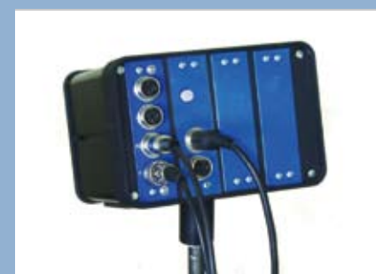
インターフェイス 気温、湿度、大気圧など必要なデータや、エンジン 回転、油温などをセンサーを通じて取込む為の装置 オプションで外部装置のデータも入力可能
