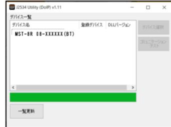
4. 接続した本体のシリアル番号とデバイス一覧に表示されたシリアル番号が一致していることを確認して、デバイス名をクリックして選択し [ デバイス選択 ] をクリックします。
