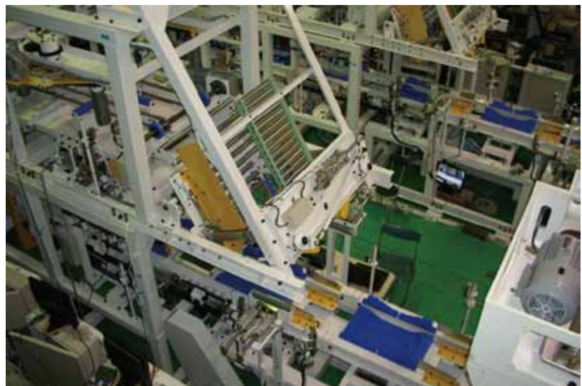
全自動式の乗用車用タイヤ組立設備
