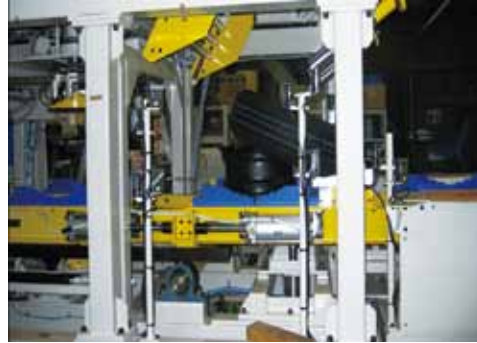
ホイールとタイヤを自動でテーブルにセットする「プリセッター」
