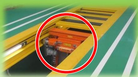
ピットジャッキ、フロアーリフトの併用設置可能！！
